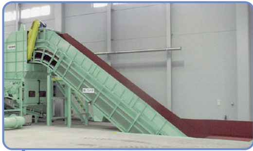
■ 投入コンベア 床より下に配置する事により 投入作業が効率よく行えます。
