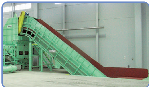
■投入コンベア 床より下に配置する事により 投入作業が効率よく行えます。
