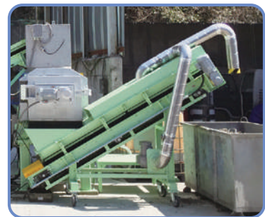
■ 冷却コンベア 風を使い固形物の冷却と 乾燥を行います。
