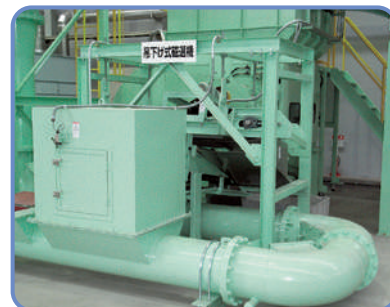
■磁選機 万が一の異物混入に備えて磁選機で 鉄類を除去します。
