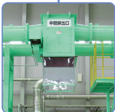
■中間搬出口 ※ラインの途中に中間搬出口を 設けてある為、破碎のみの処 理でも排出できます。
