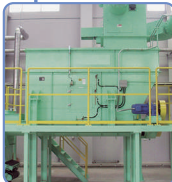
■ 貯留ホッパー付供給機 破砕した物をため徐々に 流します。
