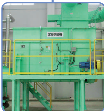
■定量供給機 (CFS-3) コンスタントに破碎物を 投入出来るフィーダーです。
