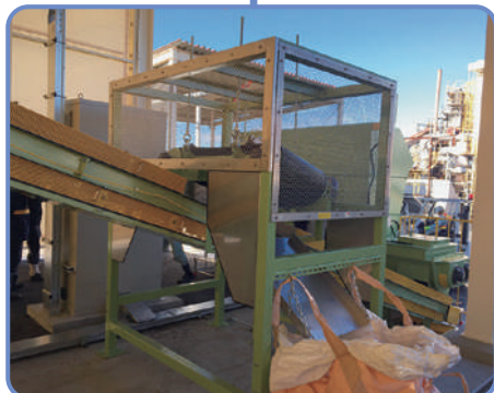
■ 磁選機 万が一の異物混入に備えて 磁選機で鉄類を除去します。
