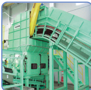
■一軸破碎機 (SA-90) 高回転のローターで細かく 破碎されます。
