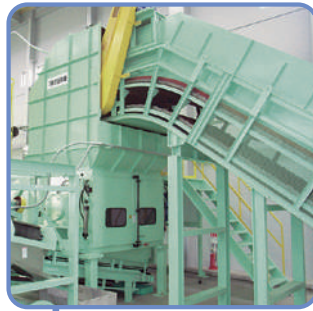
■ 一軸式破砕機 高回転のローターで細かく 破砕されます。
