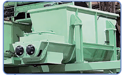
■ サージビン 脱水固形機の投入部に詰まらない様 切り出す量をコントロールします。
